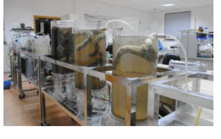
图：造纸废水处理系统实验装置
